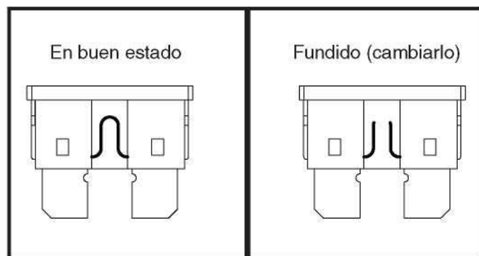
Figura 31. Cambio de fusible
