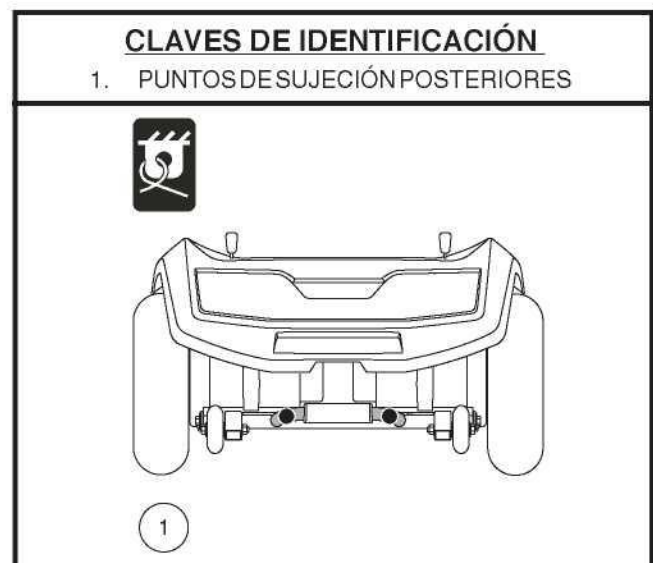
Figura 10. 710ZT - Puntos de sujeción (identificados con puntos negros)
