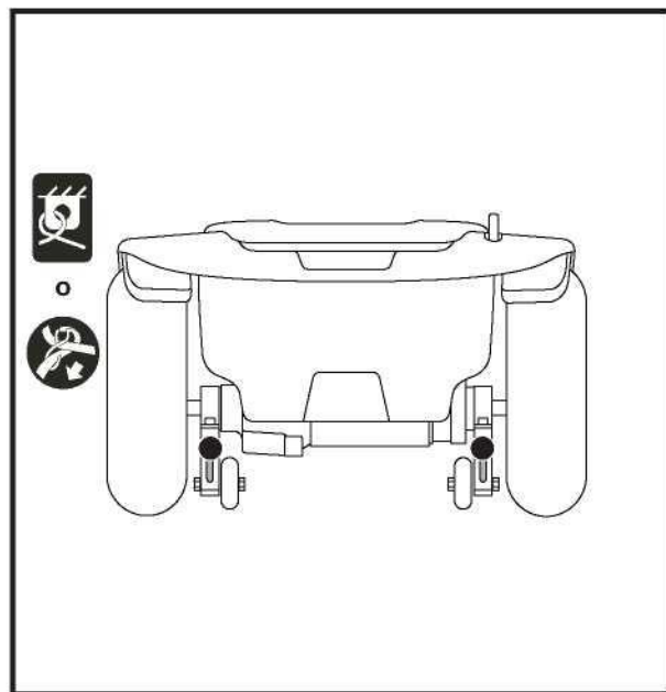
Figura 6. Puntos de sujeción posteriores (identificados con puntos negros)
