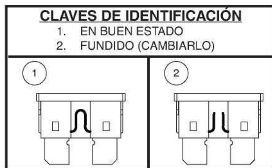
Figura 21. Cambio de fusible
