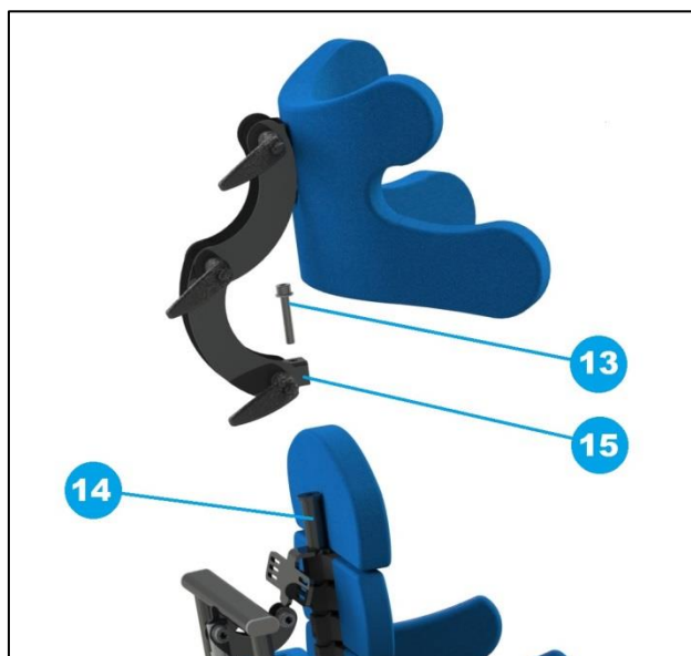
Rys. 15.1. Montaż zagłówka.
