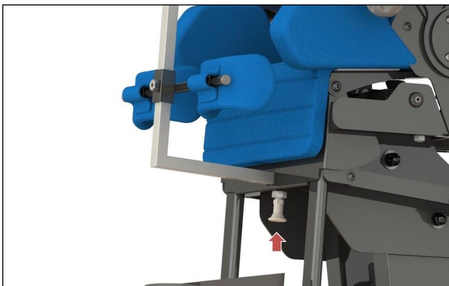
Rys. 10. Regulacja ustawienia głębokości nakolannika.
