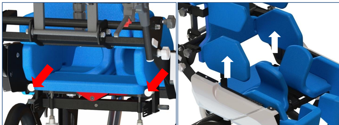
Rysunek 5: Demontaż wsporników miednicy
