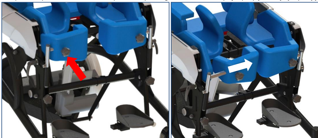
Rysunek. 21: Regulacja nakolanników
