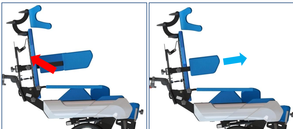
Rysunek 12: Demontaż wsporników ramion/podpaszek
