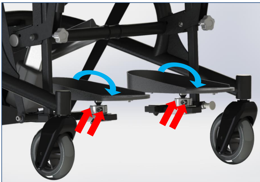
* Rysunek 17: Regulacja kąta platform stóp
