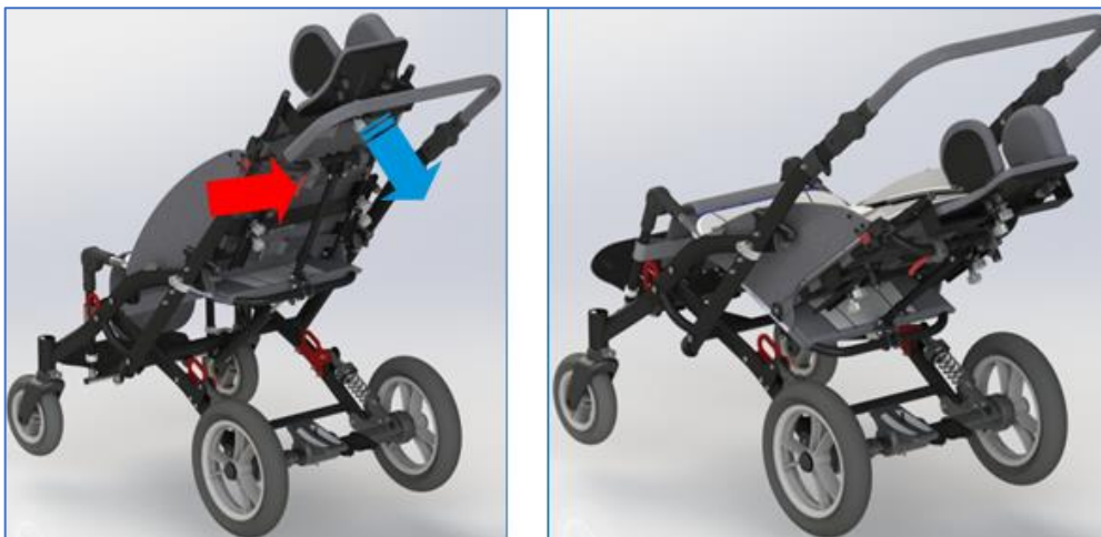
Rys. 30 Regulacja kąta siedziska
