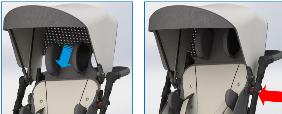
Rys. 12 Montaż budki
