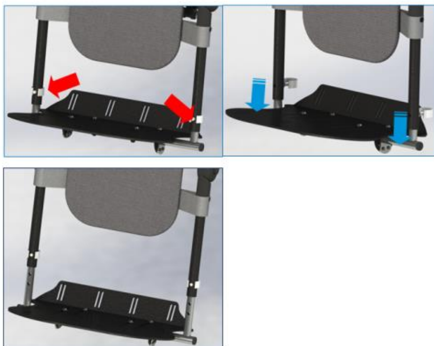
Rys. 32 Regulacja wysokości podnóżka
