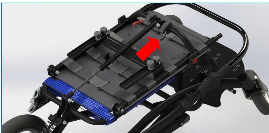
Rys. 22 Składanie oparcia pleców
