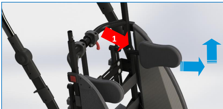
Rys. 19 Demontaż pelot piersiowych
