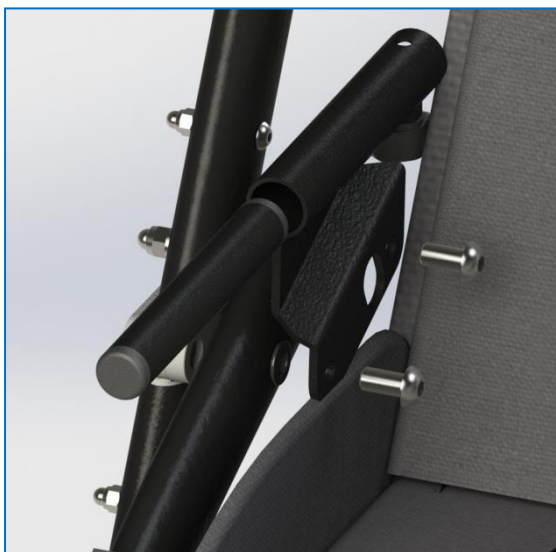
Rys. 14 Montaż mocowań stolika
