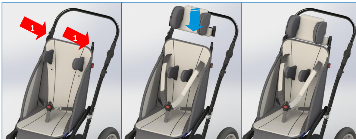
Rys. 8 Montaż pelot głowy
