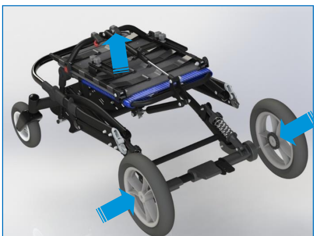
Rys. 3 Rama wózka wraz z kołami
