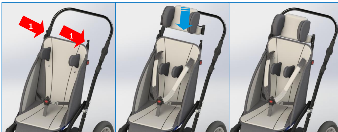
Rys. 8 Montaż pelot głowy
