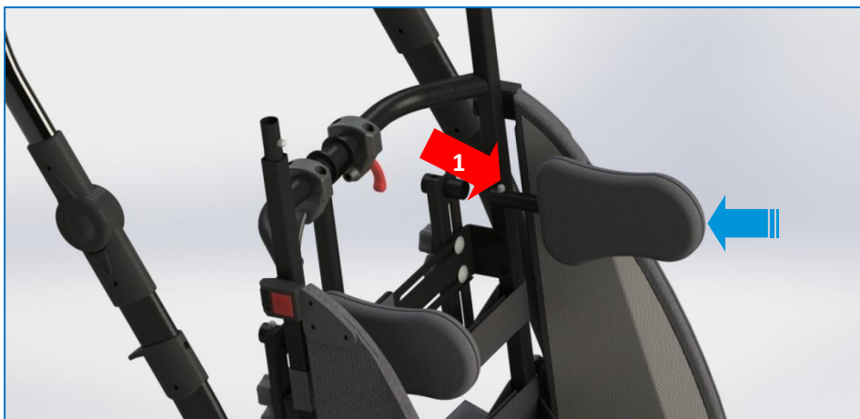
Rys. 10 Montaż pelot piersiowych
