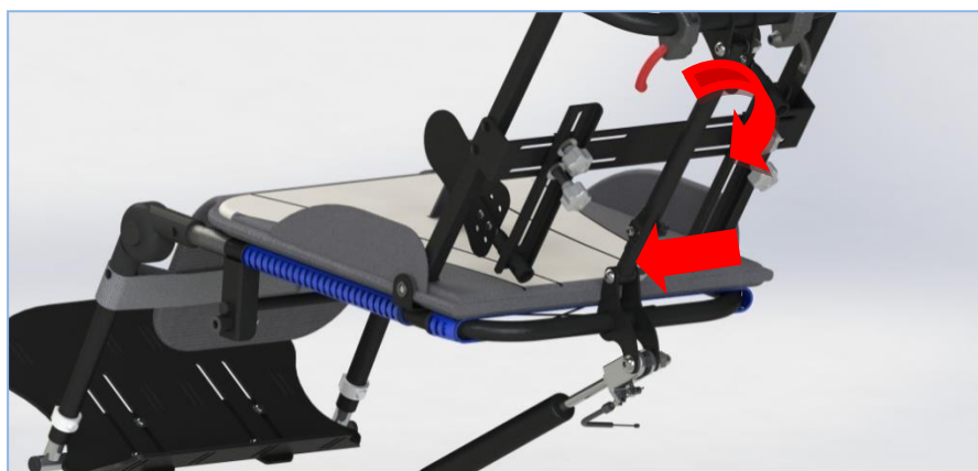
Rys. 34 Regulacja szerokości i wysokości pelot piersiowych
