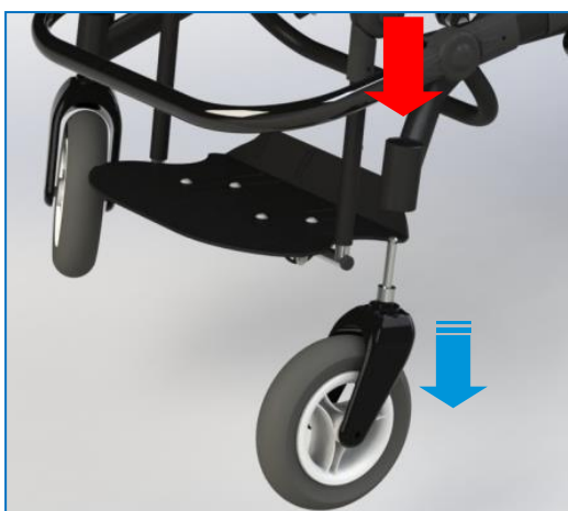
Rys. 23 Demontaż kół przednich
