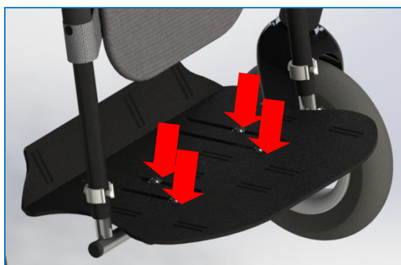
Rys. 38 Regulacja położenia platformy podnóżka
