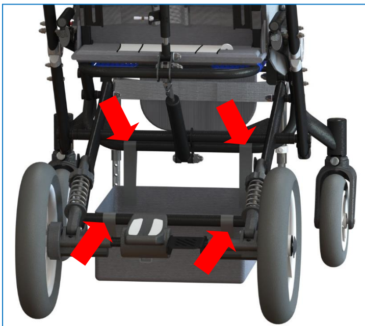
Rys. 15 Montaż koszyka podramowego
