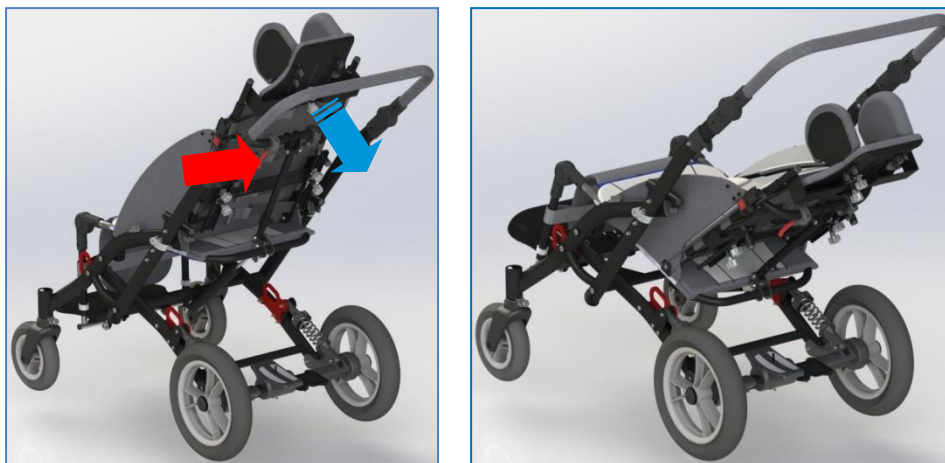
Rys. 30 Regulacja kąta siedziska
