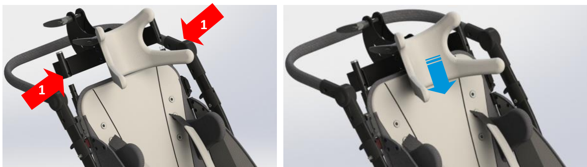
Rys. 9 Montaż zagłówka rogatego
