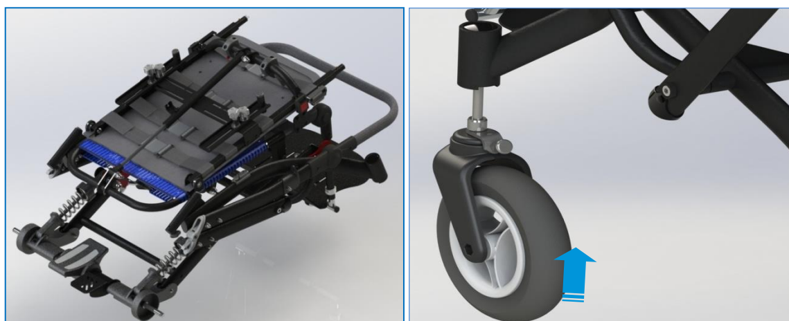
Rys. 2 Rama wózka wraz z siedziskiem
